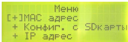
Рисунок 5.1 - Считывание MAC адреса из энергонезависимой памяти
