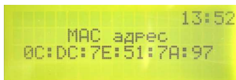
Рисунок 5.1 - Считывание MAC адреса из энергонезависимой памяти
